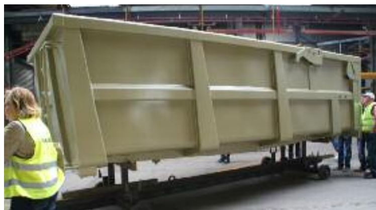
Lavage, grenailage et couche d'après sont effectués avant peinture. (DR)
