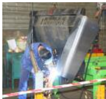
Soudure des faces avant de hérisson. (DR)
