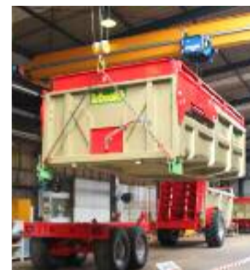
Une opération délicate, le mariage de la caisse à son châssis. (DR)
