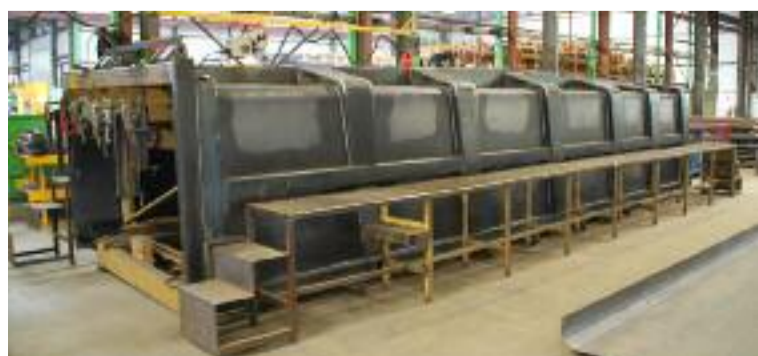
La caisse « mono coque » Leboulch est faite d'acier haute résistance élasticité ST 420 HLE. (DR)
